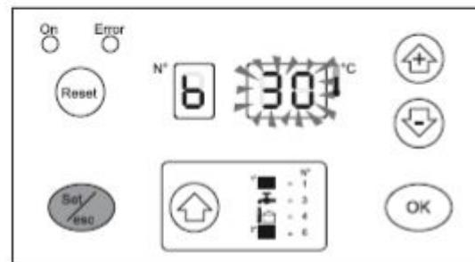
Ako je kotao spojen na bojler, mora se namjestiti parametar 6 (namješteno u tvornici 0=nema grijanja sanitарне vode). Za to se mora pristupiti načinu "Programiranja za ugraditelja" i namjestiti parametar 6 na:
