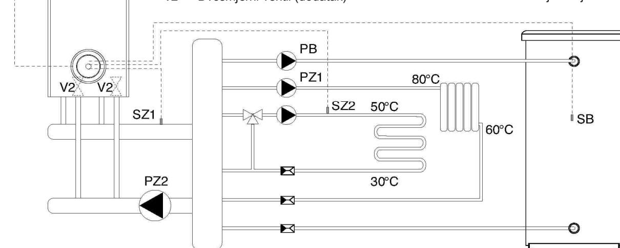
**⚠ (\*)** U ovoj konfiguraciji cirkulacijska crpka u krugu niske temperature se upravlja vanjskim termostatom (vidi parametar 34 na str. 59).
