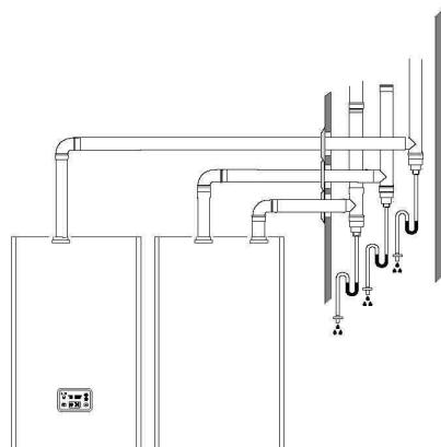
Minimalne unutrašnje dimenzijske svjetlarnika za prolaz 2 dimovodne cijevi s promjerom 50 mm
