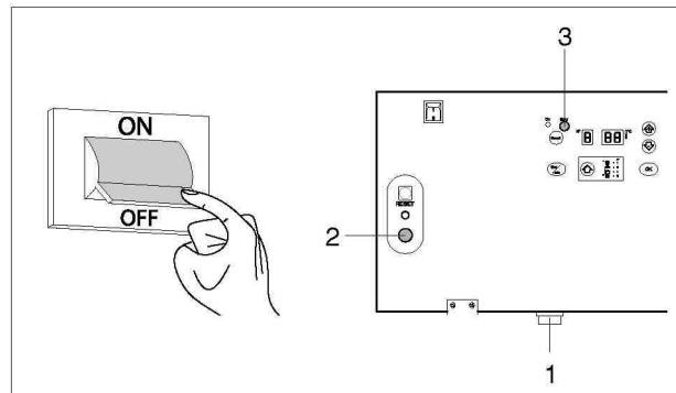
**⚠️ U ovom slučaju zaštita od smrzavanja je deaktivirana. Isprazniti instalaciju grijanja i instalaciju sanitarnih voda ako postoji opasnost od smrzavanja.**
