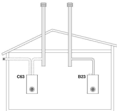
**B23** Ventilator ispred. Usis zraka direktno iz prostorije u kojoj je ugrađen kotao. Odvod proizvoda izgaranja vodoravnim ili okomitim dimovodima, uz izrađene usisne otvore.
