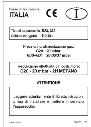
**⚠️** Oštećivanje, uklanjanje i nedostatak pločica onemogućava sigurnu identifikaciju proizvoda pa otežava svaki zahvat ugradnje i održavanja.
