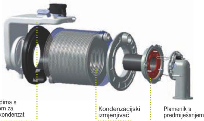
toplina omogućava rekuperaciju većeg dijela latentne topline iz dimnih plinova, smanjujući tako gubitke u dimnjaku.
