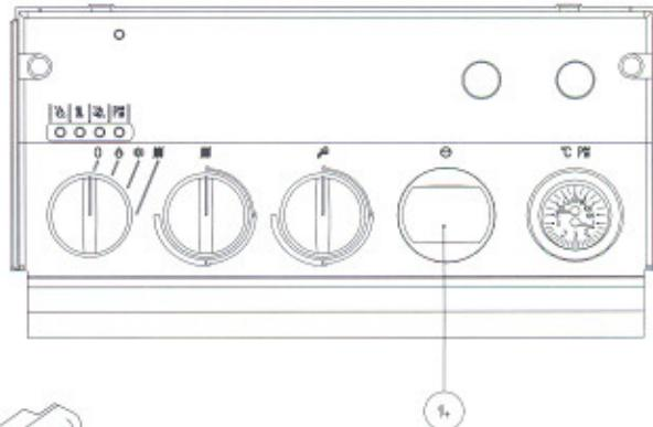
Kod otvorene ploče prisloniti sat koji ćete pričvrstiti
