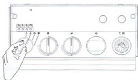
Zaokrenite (od 0° do 270°) birač temperature vode za grijanje do željenog položaja (imajući na umu da položaj na minimumu odgovara temperaturi cca. 45°C, a položaj na maksimumu temperaturi cca. 85°C).
