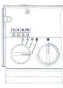
Ako je ugrađen satni programator (isporučen na zahtjev) prekidač programatora staviti na znak . Ako ga želite isključiti da biste postigli neprekidni rad, stavite prekidač programatora na "1". (Vidi uputu na str. 21).
