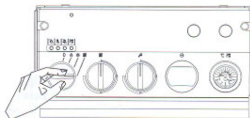
Ukoliko lampica koja pokazuje opći rad svijetli zeleno, bojler radi normalno (nastaviti sa procedurom paljenja). Ukoliko lampica svjetluca crveno postoji greška u radu bojlera (vidjeti poglavlje o radu bojlera).
