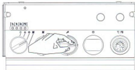
Za potpuno gašenje bojlera okrenite birač funkcije na znak "0" (vidi sl. 1) i zatvorite slavinu plina ispod bojlera (vidi sl. 2).
