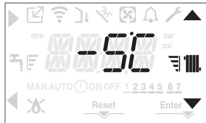
Napomena: Ako se spojen senzor vanjske temperature u svakom je slučaju moguće da kotao radi na fiksnoj vrijednosti postavljanjem parametra OTR = 0 (izbornik CH).
